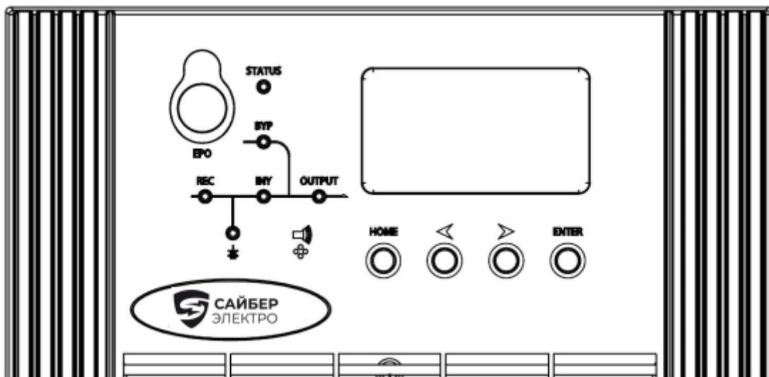
Рис.3-1 Панель оператора
