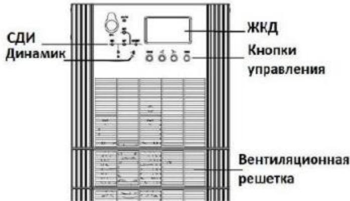
Рис. 1-7 Передняя панель ИБП 10-40кВА
