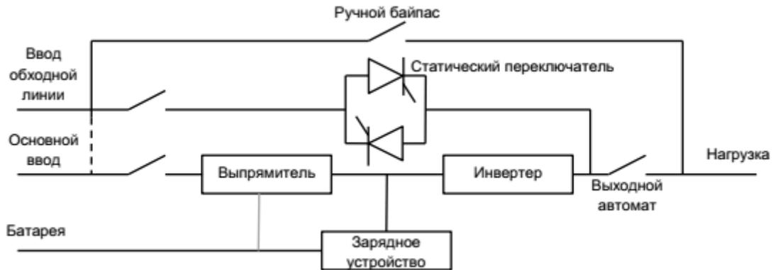
Рис.1-1 Схема ИБП
