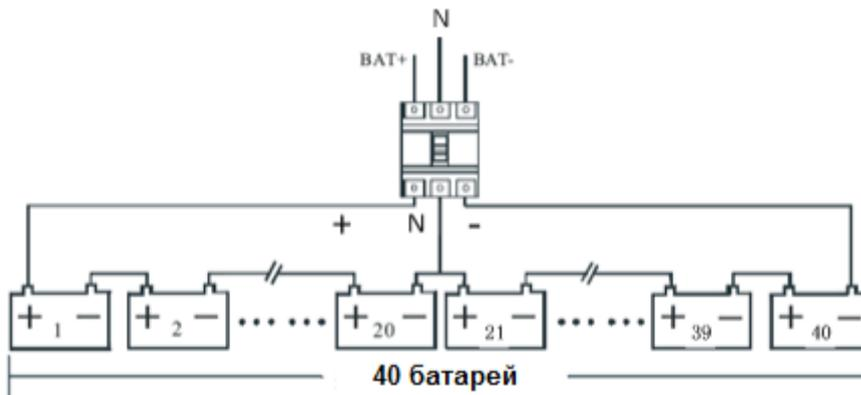
Рис. 2-9 Подключение батарей
