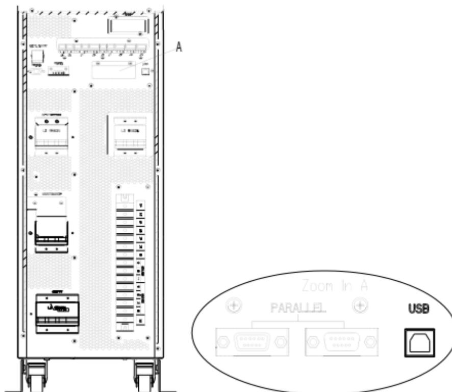
Рис.4-7 Расположение карты параллельной работы
