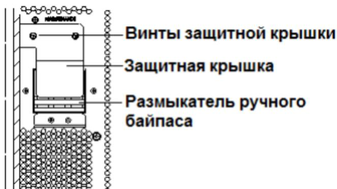
Рис. 4-2 Защитная крышка ручного байпаса
