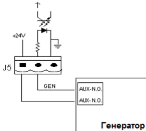
Рис. 2-17 Схема разъема «Работа с генератором»
