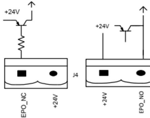
Рис. 2-16 Схема разъема системы экстренного отключения (ЕРО)
