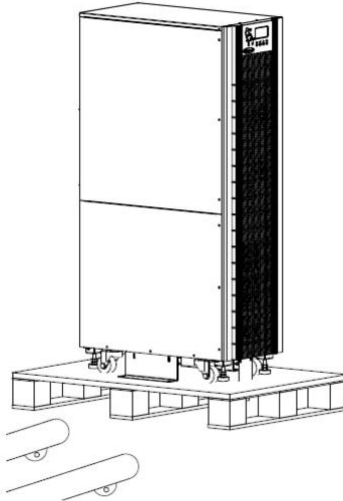
*Рис. 2-7 Снятие защитного пенопласта*
