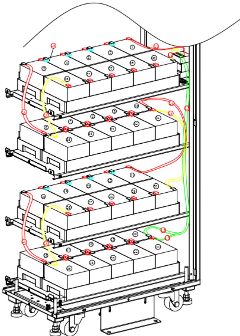
Рис. 5-2-1 Соединение батарей
