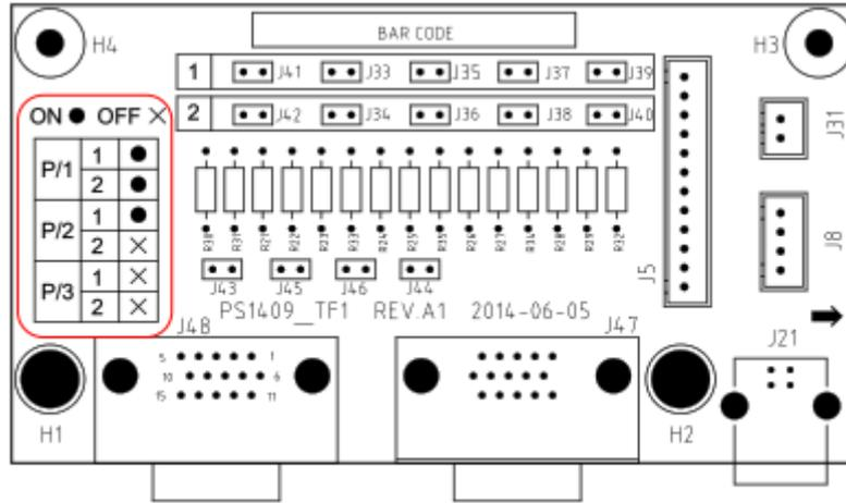
Рис.4-11 Расположение джамперов на карте параллельной работы (PS1409\_TF1)
