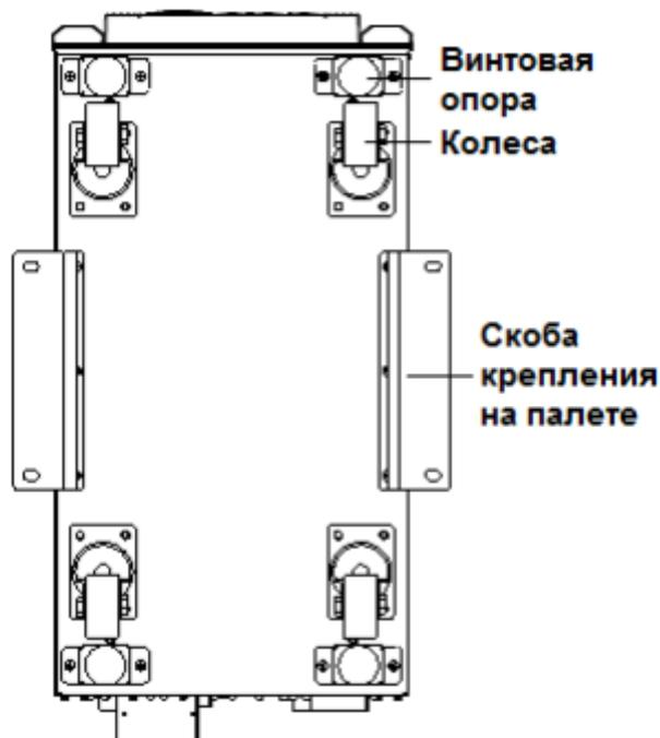
Рис. 2-8 Винтовые опоры и колеса (вид снизу)
